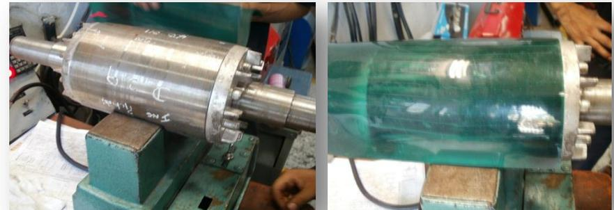
**Prueba rotor bloqueado o alimentación monofásica:** La conexión del equipo es  $\Delta$  para 460 voltios y 31,6 amperios. Los terminales de conexión van según la norma IEC como lo muestra el siguiente gráfico:
